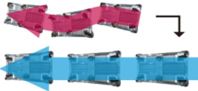
直進方向への規制ができることで、蛇行することがなく、積載物の荷崩れや転倒を防ぐことができます。
